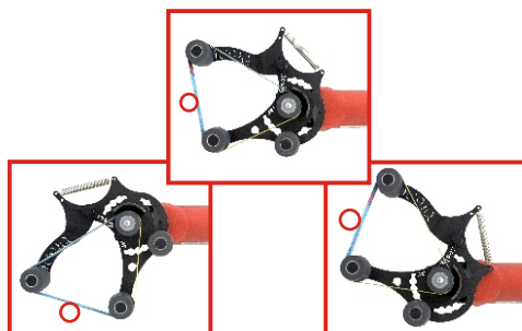
- optimale Stellung der REGRA für bequemes Arbeiten - 6 Einstellungen /Beispiel
