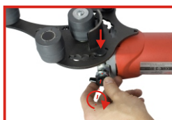
- Spannfuß anstecken und mit Spannschrauben befestigen
