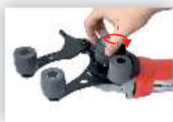
przykręcenie rolki napędowej
