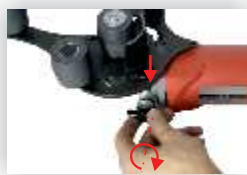
włożenie łap i przykręcenie do szlifierek pokrętłami mocującymi
